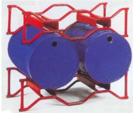
Cette palette à fûts empilables est fabriquée en tubes d'acier de 30 mm de diamètre et est manipulable par chariot élévateur. 2 niveaux de fûts maximum.
