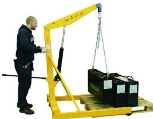
Dotée de petites roues, cette **grue d'atelier** se déplace facilement d'un bout à l'autre de votre atelier et de votre entrepôt. Elle est équipée d'une valve de sécurité pour vous garantir une utilisation simplifiée et parfaitement sécurisée. Cette [grue d'atelier à longerons encadrants](#) vous permettra d'élever vos charges les plus lourds ... allant de 700 kg jusqu'à 1000 kg. N'hésitez plus, commandez dès maintenant votre matériel de levage robuste et de qualité professionnelle !
