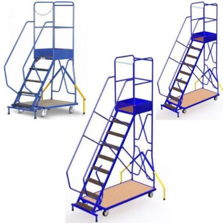
L'escabeau mobile avec stabilisateurs automatiques possède un garde-corps ainsi qu'une chaîne anti-chute. La stabilité de l'escabeau est renforcée par une base de forme trapézoïdale. La plateforme supérieure est en **bois anti-dérapant** pour éviter tous risques de glissade.
