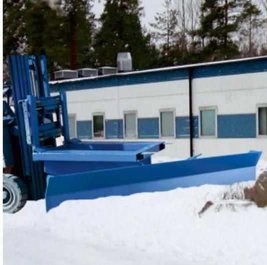
Entièrement réglable, cette **lame chasse-neige** dispose de 3 positions et s'oriente à gauche, à droite et sur le devant. Son renfort sur l'arête frontale permet une plus longue durabilité, à l'instar de son mécanisme à ressort et de son verrouillage de fourches. Afin d'apporter plus de sécurité, sa lame se rétracte automatiquement en cas de collision.
