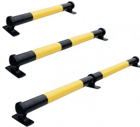
Cette butée de parking limite la zone de recul d'un véhicule sur une place de parking, il protège une façade ou une zone en arrière-plan de stationnement. Fait entièrement d'acier avec un **tube Ø75mm x 3mm d'épaisseur**, ses pieds sont en fonte et sa peinture époxy est de couleur jaune et noir.
