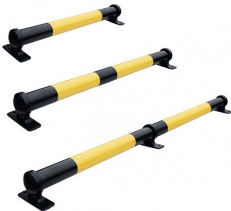
Cette butée de parking limite la zone de recul d'un véhicule sur une place de parking, il protéger une façade ou une zone en arrière-plan de stationnement. Fait entièrement d'acier avec un **tube Ø75mm x 3mm d'épaisseur**, ses pieds sont en fonte et sa peinture époxy est de couleur jaune et noir.
